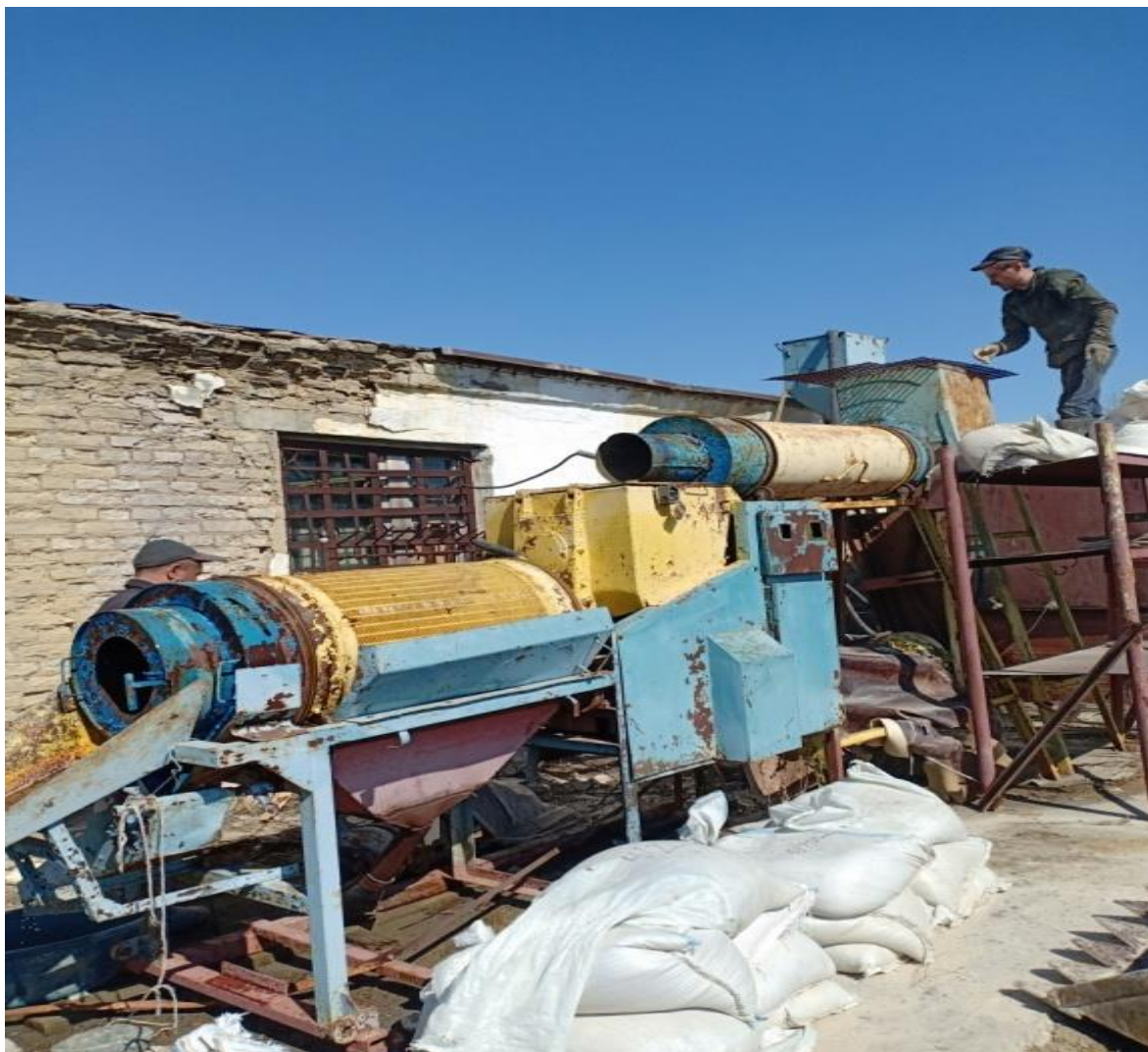
20 сурет – Екібастұз көмірінің күлқож қалдықтары материалын скруббер – бутарада дезинтеграциялаудың және жіктеудің технологиялық процесі
